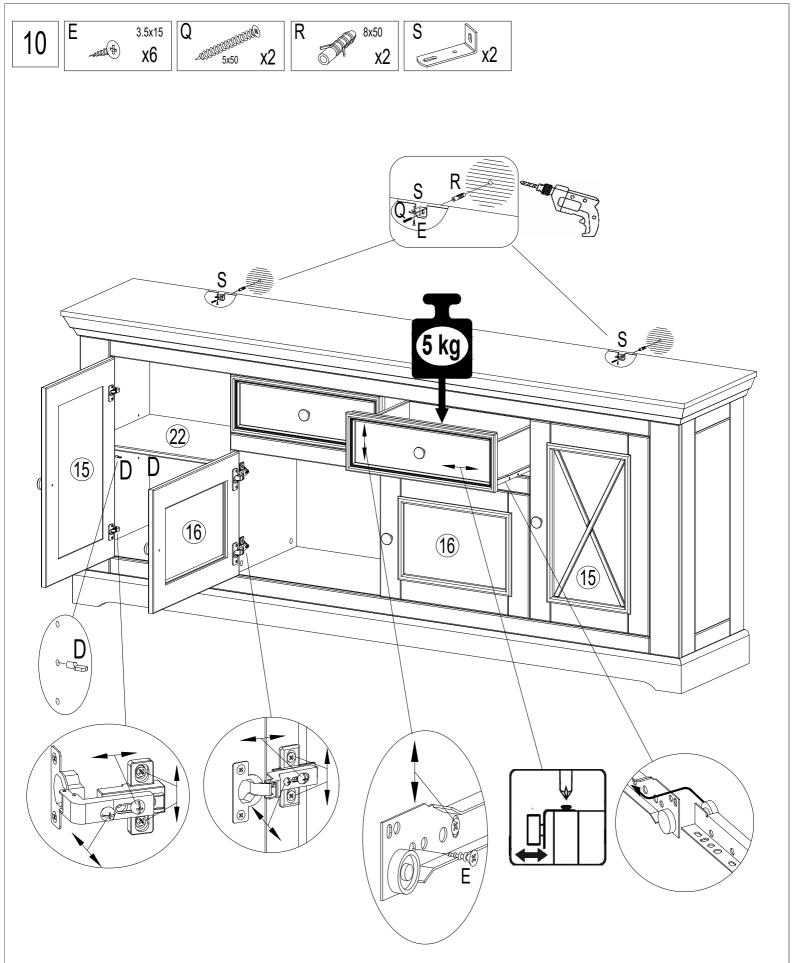
"Die Schubkastenschiene kann bei Bedarf durch Lösen und Fixieren der Schraube am Langloch eingestellt und nachjustiert werden"
